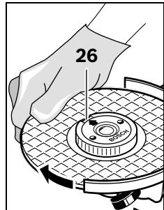
使用主軸鎖定鍵 2 固定主軸。然後朝著順時針的方向用力地轉動砂輪，以便擰緊快速螺母。
