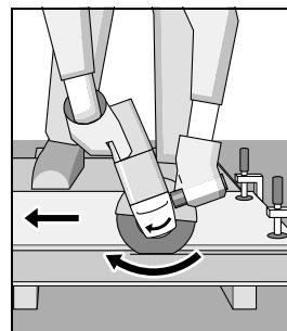
Máy luôn luôn phải được vận hành theo chuyển động mài ở tư thế thẳng đứng. Nếu không như vậy, có sẵn nguy cơ bị dây mà không điều khiển được máy ra khỏi mạch cắt.
