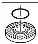
ขันพลาสติก (โอ-ริง) จะติดตั้งอยู่รอบ บ่าตวงกลางของน่อต้องจากน 8 ทาง โอ-ริง หายหรือชำรุด ต้องเปลี่ยน น่อต้องจากน 8 ใหม่ก่อนเริ่มใช้งาน เครื่องต่อไป
