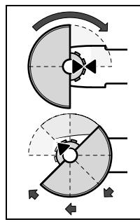
参考插图把防护罩 12 安装在主轴颈上。防护罩上的三角形记号，必须和机器传动头上的三角形记号相对。把防护罩 12 推入主轴颈中，并让防护罩上的突起正确地套在电动工具的法兰上，接著再转动防护罩至能够清楚地听见卡牢声响为止。
