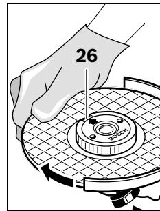
使用主轴锁定键 2 固定主轴。然后朝著顺时针的方向用力地转动砂轮，以便拧紧快速螺母。
