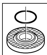
Chi tiết bằng nhựa (vòng đệm chữ O) được lắp vào vành định tâm của bích lắp 8. Nếu vòng đệm chữ O bị mất hay bị hư, phải thay bích lắp 8 trước khi cho máy hoạt động trở lại.
