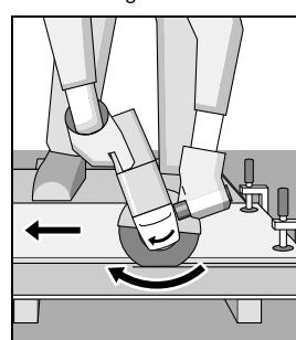
Arah pemotongan harus selalu berlawanan dengan arah gerak dari alat kerja. Jika tidak, ada bahaya perkakas listrik terlompat **dengan tiba-tiba** dari jalur pemotongan.
