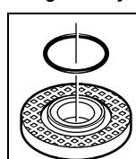
Di dalam flens untuk poros kerja **8** di sekitar tingkat pemusatan ada satu bagian dari bahan sintetik (ring-O).
