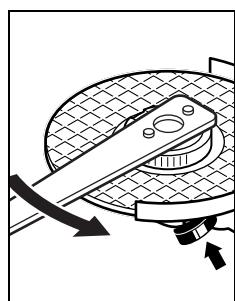
如果安裝正確，而且快速螺母未損壞的話，一般可以用手朝著逆時針方向轉松快速螺母。
