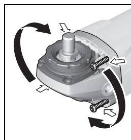
Kepala mesin dapat diputar dalam langkah masing-masing sebesar 90°. Dengan demikian untuk berbagai pekerjaan yang khusus, tombol untuk menghidupkan dan mematikan mesin bisa diganti kedudukannya ke kedudukan yang lebih cocok, misalnya untuk memotong dengan kap penghisap dengan mistar jarak **21** atau untuk orang kidal.
