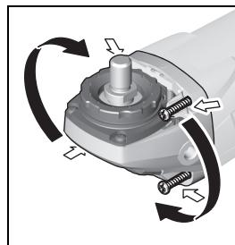
ขั้นสกอร์ทั้งสี่ตัวออกจนสด หมุนหัวเครื่องไปยังด้านแห่งใหม่ อย่างไรมันดีกว่า โดยไม่กดต้องจากตัวลัง ขั้นสกอร์ทั้งสี่กลับเข้าไปในล้อได้ใช่ไหม
