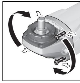
Đầu máy có thể xoay được đối với vỏ máy ở vào  $90^{\circ}$  nắc. Bằng cách này, công tắc Tắt/Mở có thể mang lại vị trí thuận lợi hơn đối với các tình huống gia công đặt biệt, vd., gia công cắt có sử dụng đường cắt có chắn bảo vệ
