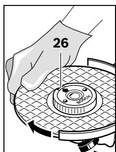
Tekan tombol penahan poros kerja **2** untuk menahan poros kerja. Untuk mengencangkan mur untuk poros kerja yang dibuka dan dikunci dengan tangan, putarkan mata gerinda dalam arah jalannya jarum jam dengan keras.
