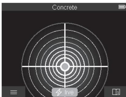
在<点视图>中，将显示第一个测量结果，无需将测量仪移动到基底上方。因此该视图特别适用于角落里或狭窄部位上的测量。最大探测深度为6厘米。获寻物可能一同显示材料属性，但不显示深度数据。
