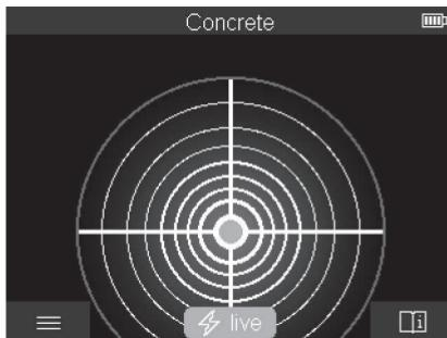
無須將測量工具在基材上移動，即已在 <**定點畫面**> 上顯示第一個測試結果。因此特別適合用於邊角或狹窄處的測量。最大探測深度是 6 公分。找到的物體可能視情況顯示其材質屬性，但無深度資料。
